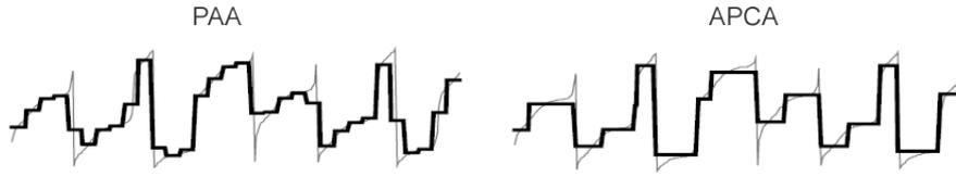
**Figura 5. Comparação visual dos métodos PAA e APCA [Keogh et al. 2001].**
