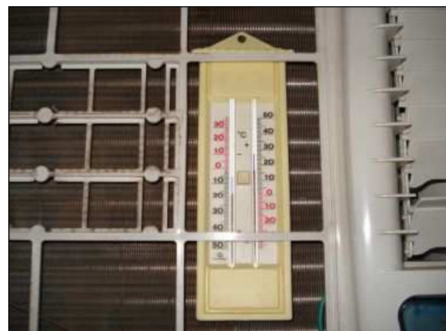
FIGURA 2 POSIÇÃO DO TERMÔMETRO MODELO MÁXIMA E MÍNIMA NO CA.
