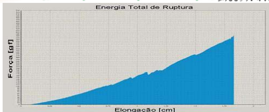
Figura 2: Gráfico Força x Elongação – o valor da força no momento da ruptura corresponde à FRT e a área sob a curva corresponde a ETR (WU, 2003). O término do experimento se dá com a ruptura da alça, momento esse identificado pela queda brusca do registro do polígrafo, voltando à linha de base zero, em virtude da perda do líquido (Figura 3) (WU, 2003). Desse modo, foram realizados os ensaios em todos os espécimes, sendo obtidos os respectivos valores da força de ruptura à tração e da Energia Total de Ruptura. Com os valores alcançados na sua totalidade, foram calculados a média, o desvio padrão, o erro padrão e o coeficiente de variação, os quais foram utilizados para comparação.
